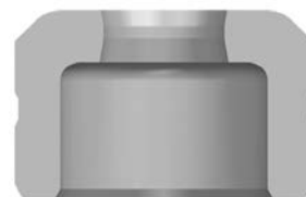
Тип Е : 3 выступа под разными углами предупреждают обратный выброс
