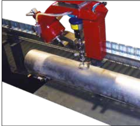
Система резки труб Tube cutting lathe system
