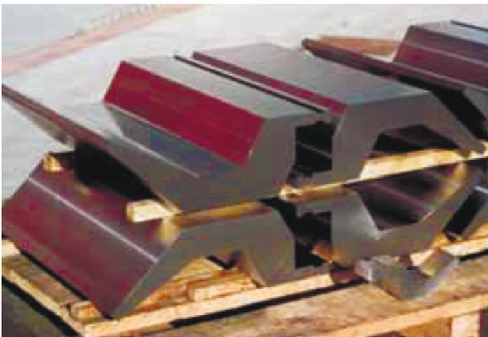
**20.51 MATRICE CON RULLINI / LOWER DIE WITH ROLLERS / МАТРИЦА С ОПОРНЫМИ РОЛИКАМИ**
