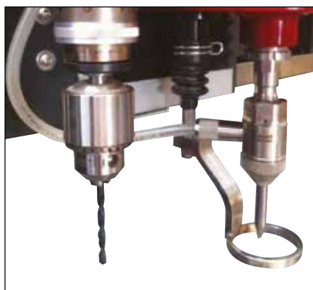
Механическое устройство с ЧПУ для сверления и снятия фаски Pre-drilling and Counter Sink CNC mechanical system
